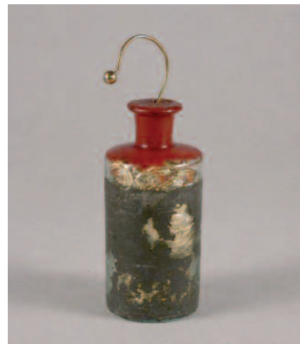
La botella de Leyden, antecesora del capacitor. Cuando se conectaba el gancho a una fuente de energía estática, la botella se cargaba.
